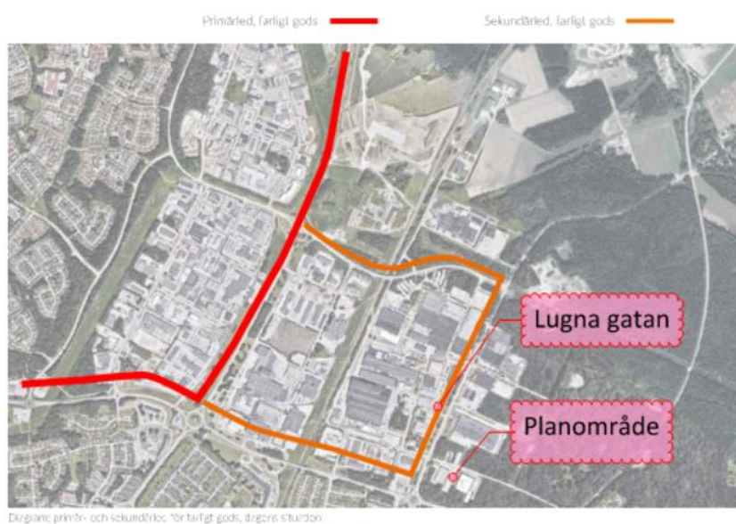
Figur 6 Befintliga vägar för farligt gods. Röda vägar avser primära vägar för farligt gods vilket innebär att genomfartstrafik för farligt gods förekommer. Orangea vägar avser sekundära vägar för farligt gods vilket innebär att enbart transporter till närliggande områden förekommer. (Markeringar i text gjorda av BSL i programplan, 2021)
