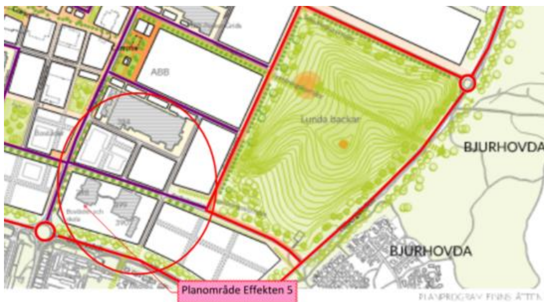
Figur 8 Verksamheter som kan medföra transporter på Fredholmsgatan är de verksamheter som ligger inom den röda cirkeln. Huvudgator för tung trafik är markerade i rött och primärgata för tung trafik i lila. (Markeringar gjorda av BSL i planprogram, 2021).
